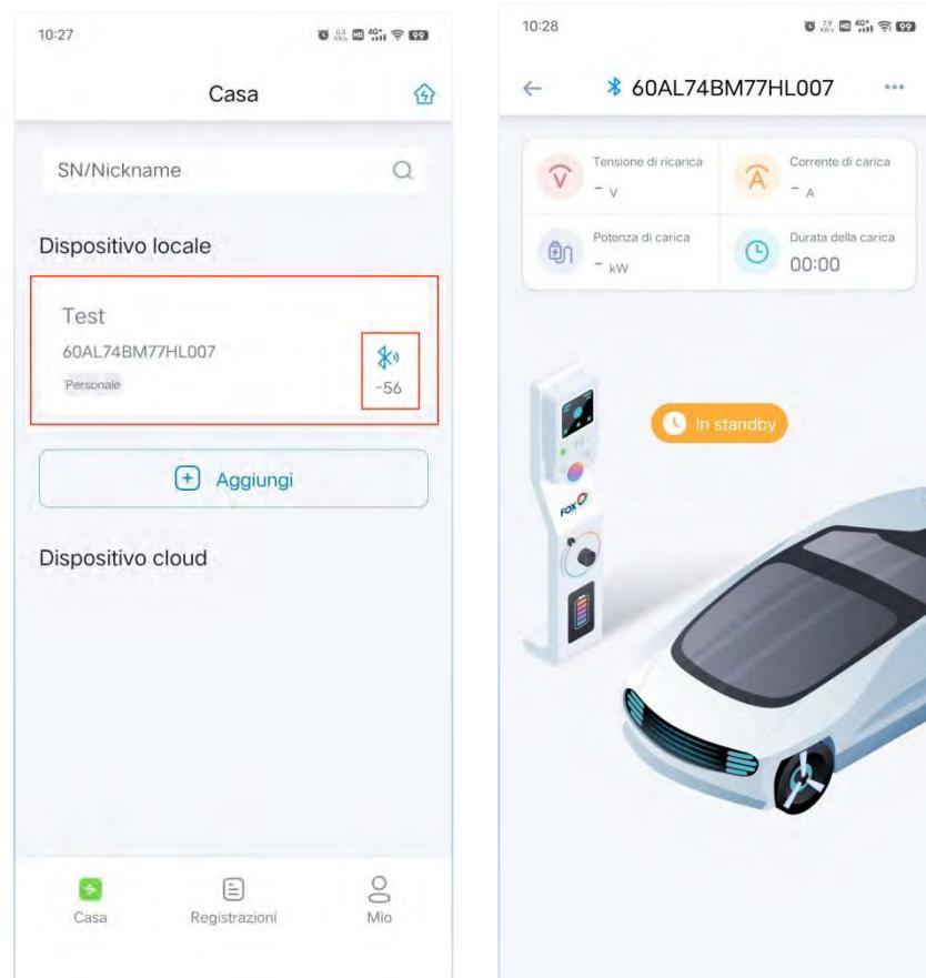
**Nota:** Per garantire la stabilità della connessione Bluetooth, collegati al caricabatterie EV 3 minuti dopo averlo acceso. In modalità Bluetooth, puoi entrare nell'interfaccia di controllo del caricabatterie EV per configurare il caricabatterie EV.
