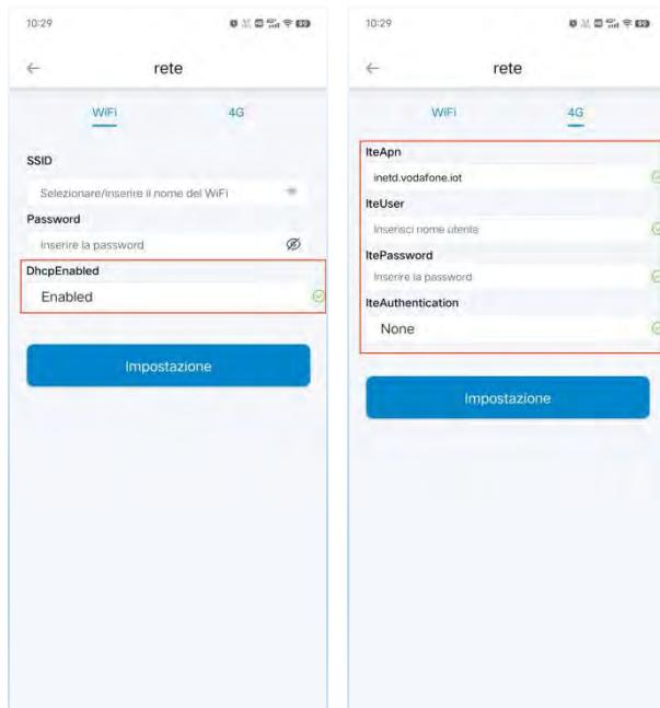
**Nota:** Per garantire la stabilità della configurazione di rete, si consiglia di spegnere l'alimentazione e riavviare il caricabatterie EV dopo la configurazione di rete. Puoi connetterti alla rete e accedere al Cloud entro 3 minuti dopo il riavvio. In modalità Cloud, l'intervallo di caricamento dei dati di ricarica del
