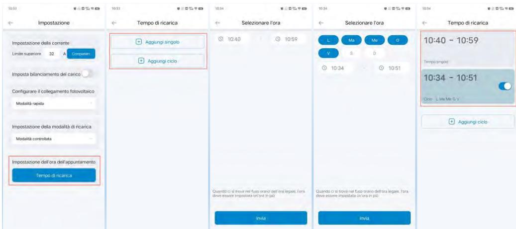
**Nota:** Per la ricarica programmata, è possibile impostare solo l'orario di ricarica programmata in stato di stand-by in modalità controllata.
